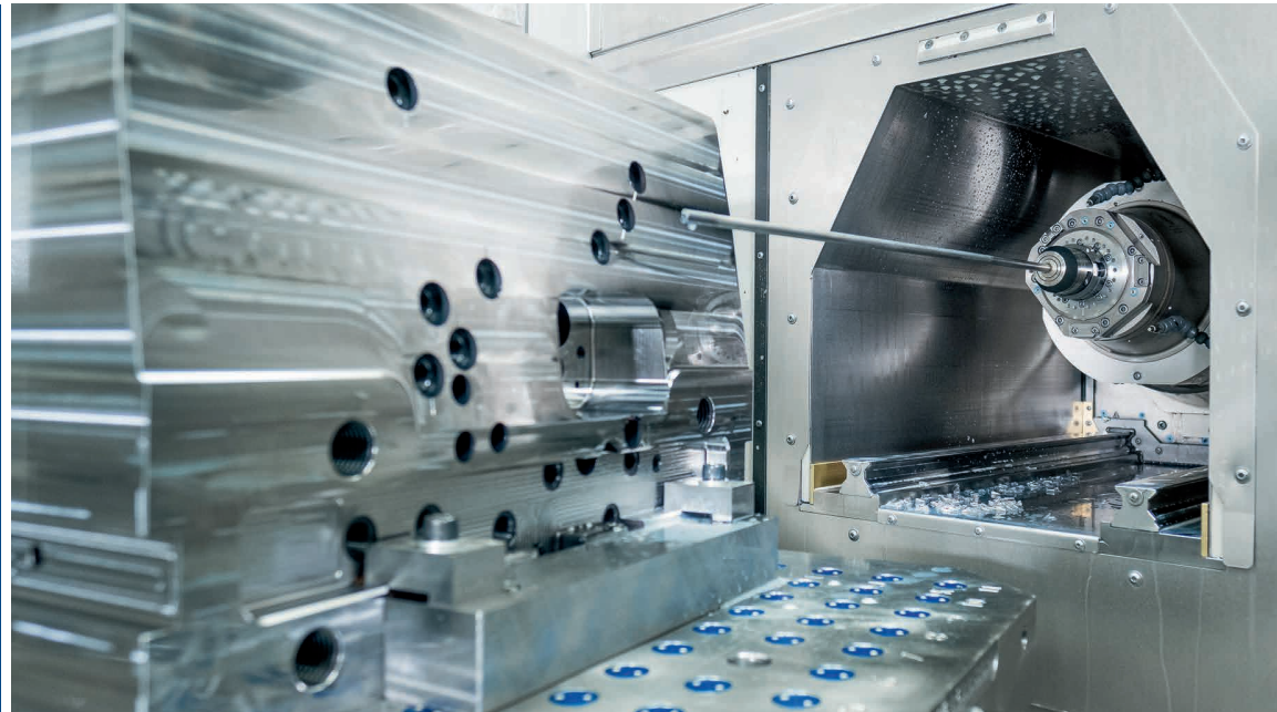
Tieflochbohren auf einer G550 – Einsatz überlanger Werkzeuge ohne Einschränkungen der maximalen Werkstückgröße
