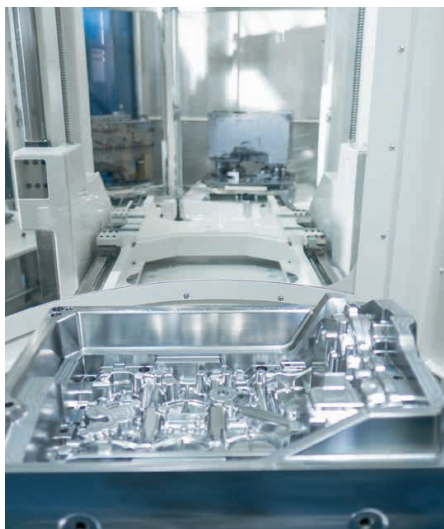
Automatisierungslösung von GROB – das Palettenrundspeichersystem PSS-R
