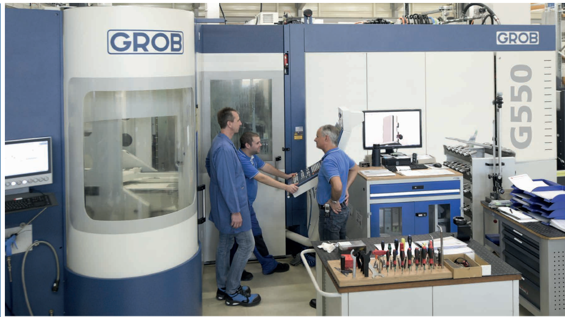
GROB G550 – 5-Achs-Universal-Bearbeitungszentrum bei POLAR-FORM Werkzeugbau GmbH
