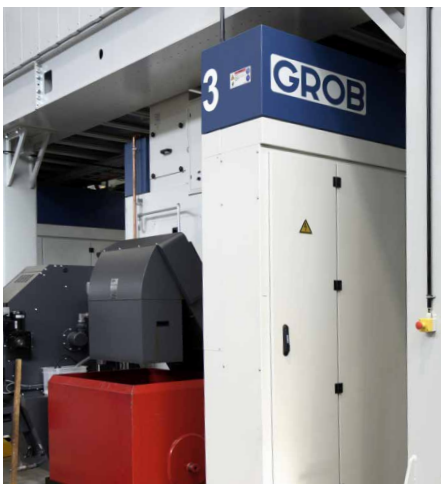
Die GROB G750 ist extrem kompakt und platzsparend, Späneförderer und Kühlmitteltank sind direkt in der Maschine integriert und brauchen keine zusätzlichen Stellflächen neben der Maschine.
