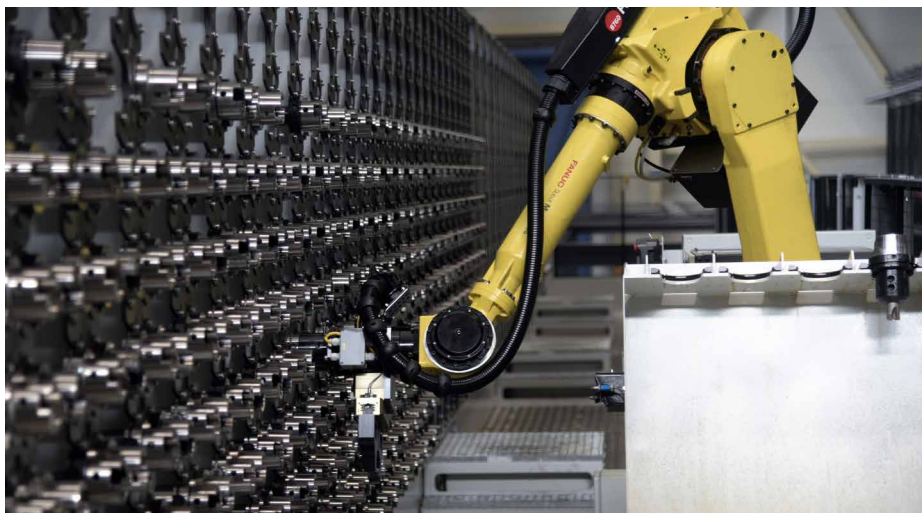
Das zentrale Werkzeugmagazin mit 870 Werkzeugen HSK-A100 ermöglicht die maximale Flexibilität der Gesamtanlage, weil jedes Bauteil in jeder Maschine bearbeitet werden kann. Der Roboter hat zusätzlich einen Rucksack für noch schnelleres Be- und Entladen der Werkzeuge.
