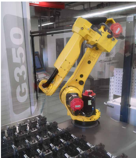
FANUC Knickarm-Roboter mit Schraubstockgreifer und Lang Robo Trex Automation mit zwei Automationswägen und je 30 5-Achsspannern.
