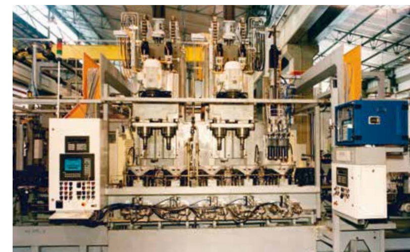
1996: Transferstraße für Zylinderkurbelgehäuse
