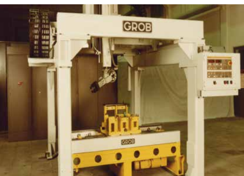
Roboterbeladung in Portalausführung
