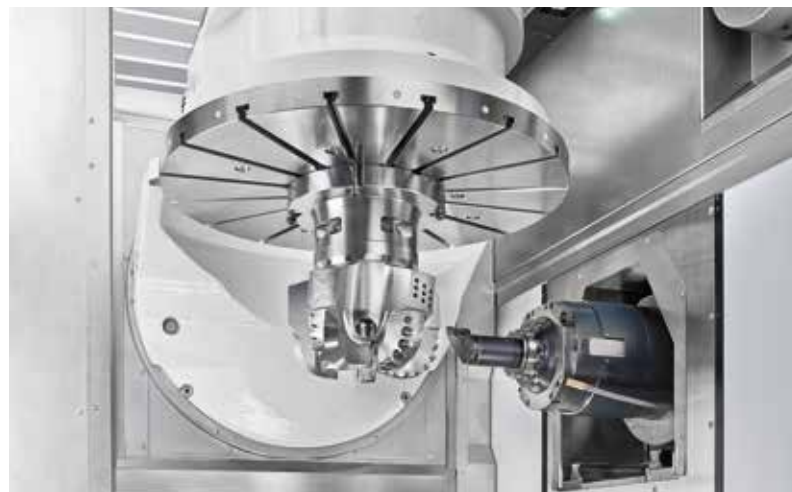
5-Achs-Bearbeitung einer Bohrkronen-Überkopf mit freiem Spänefall
