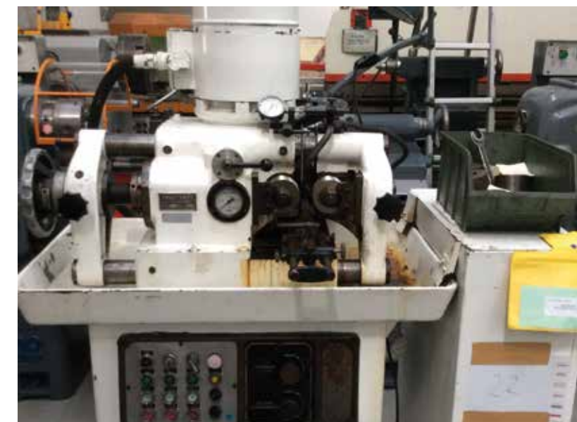
Erste Gewinderollmaschine Modell RMOa Nr. 181 – noch heute in Betrieb in Italien
