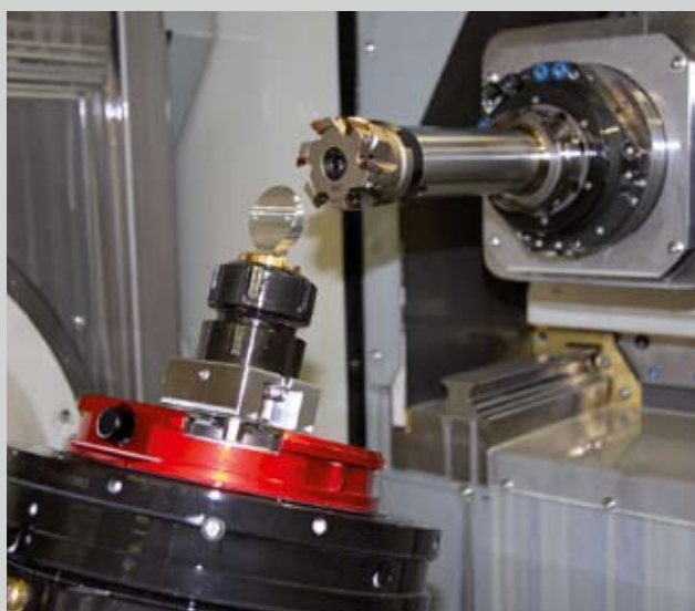
Auch für die Einzelteillfertigung ist die Palettisierung optimal einsetzbar. Hier kann die volle 5-Achs-Simultan-Bearbeitung der GROB G350 genutzt werden.
