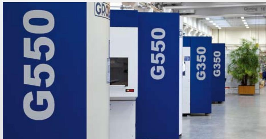
Alle G-Modul-Baureihen haben eine gemeinsame Struktur und Bauweise über alle Baugruppen als Grundlage. Die Baugruppen der G350 und G550 sind völlig identisch mit denen der Baugröße G300 und G500, in ein- und zweispindiger Ausführung. Sie erfüllen die flexiblen Anforderungen des Flächenmarktes, besitzen gleichzeitig die hohe Genauigkeit und Präzision von Anlagen in der Automobilindustrie und werden damit zu sogenannten Alleskönnern.
