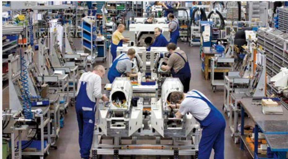
Ein eigens entwickeltes Shopfloor-Management bindet die Mitarbeiter in die getaktete Fließmontage der Funktionsgruppen ein. Modernste IT-Unterstützung macht die Materialverfügbarkeit in Echtzeit transparent und sorgt so für eine optimale Logistikversorgung.
