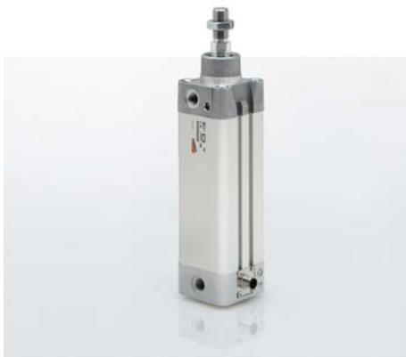
Die Camozzi AG präsentiert auf der EMO die neuen pneumatischen Stellantriebe der Serie 6PF, die in idealer Weise das umfangreiche Zylinderprogramm von Camozzi vervollständigen. Sie dienen zur Einbindung von Antrieben in geschlossenen Regelkreisen und zur Prozessdokumentation. Ausgestattet sind sie mit einem linearen potenziometrischen Positionsgeber, der in die Kolbenstange integriert ist.
