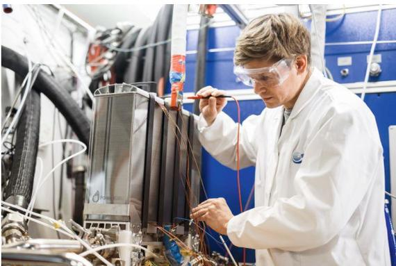
Im Forschungsprojekt „HyFaB“ entwickeln und erproben Wissenschaftlerinnen und Wissenschaftler vom Zentrum für Sonnenenergie- und Wasserstoff-Forschung Baden-Württemberg (ZSW) in Kooperation mit dem Fraunhofer-Institut (ISE) automatisierte Fertigungs- und Qualitätssicherungsverfahren für Brennstoffzellenstacks. Seit Anfang dieses Jahres
