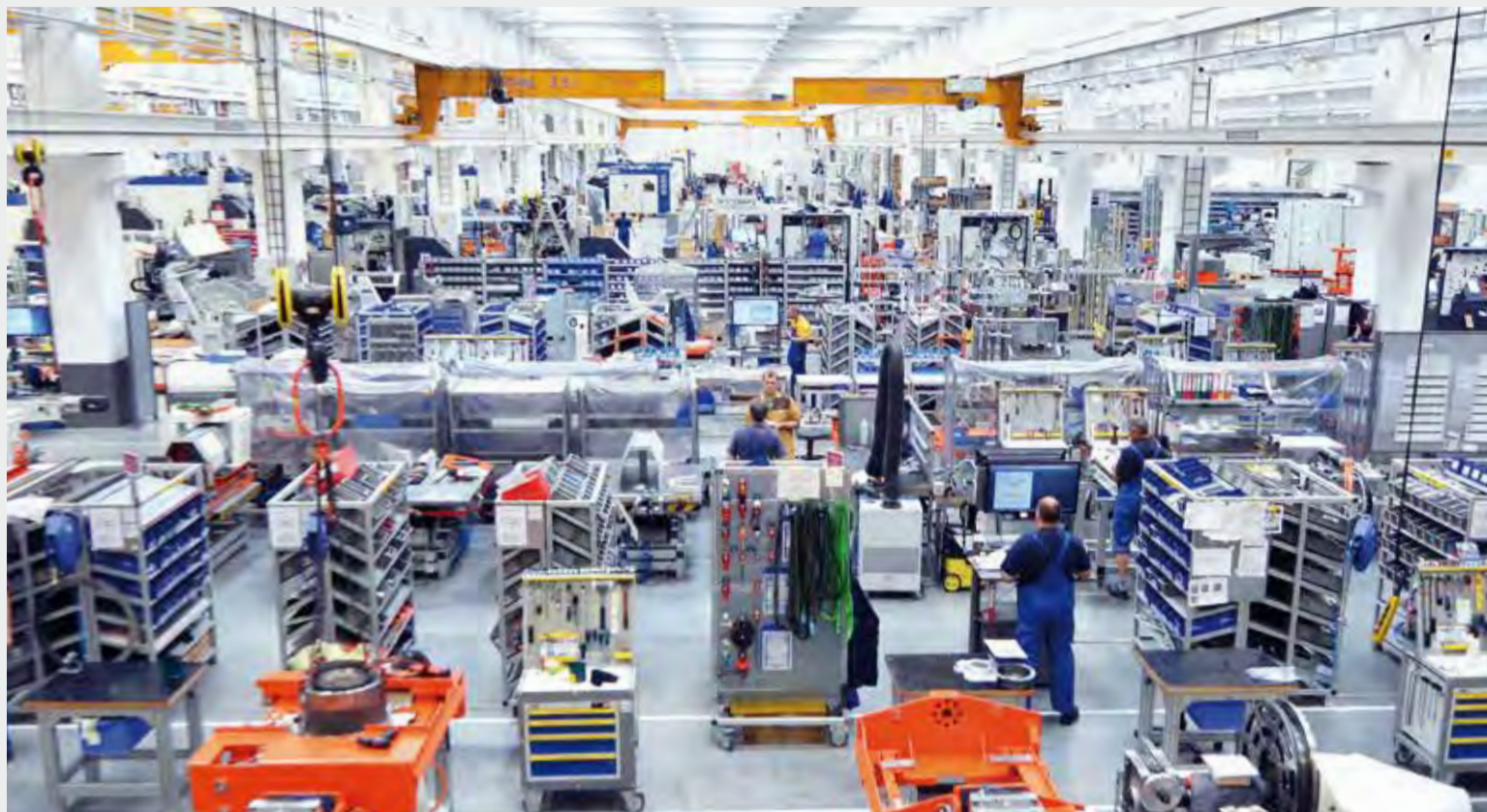
Baugruppenvormontage der Universalmaschinen in Halle 9
