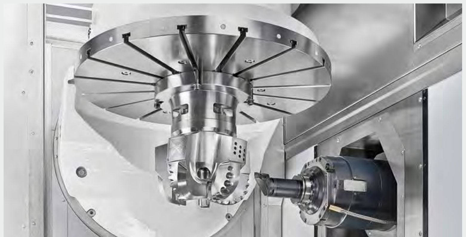
Bearbeitung einer Bohrkronen bei nur einer Aufspannung auf einem GROB 5-Achs Universal-Fräs-Dreh-Bearbeitungszentrum
