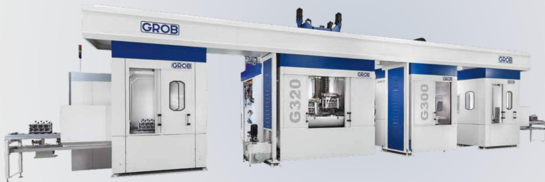
**In den Außenabmessungen kleiner, in allen Bewegungsabläufen dynamischer, eine vergrößerte Werkzeugkapazität und ein schnellerer hauptzeitparalleler Werkzeugwechsel. Das sind die GROB-Innovationen der G-Baureihe G300 und G320, die erstmals auf der EMO in Mailand der Öffentlichkeit vorgestellt werden.**
