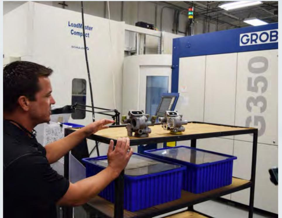
Qualitätskontrolle eines Guss-Stücks und eines fertigen Teils eines Kraftstoffverteilers, der auf einer GROB G350 gefertigt wurde
