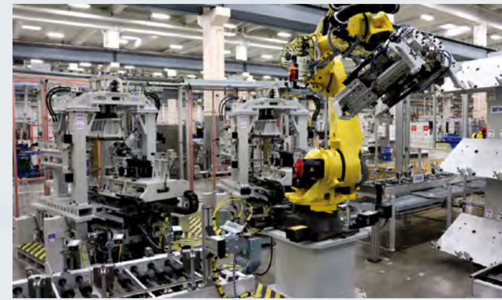
Leaktest-Station für kurze Rüstzeiten bei neuen Werkstücktypen
