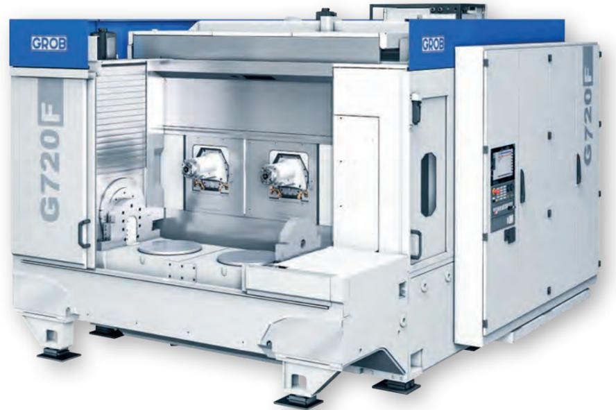
**Mit der F-Serie werden in erster Linie Subframes und Batteriewannen bearbeitet.**
